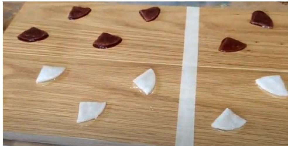
Тестируемое изделие имеет две стороны: одна покрыта маслом с помощью ветоши, другая – кистью. Оставляем на несколько часов до полного высыхания.
